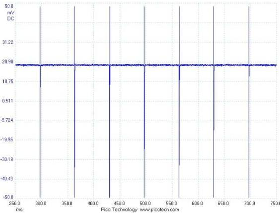
Figura 6 - Diagramma temporale del campo elettrico emesso durante una tecar terapia in modalità capacitiva
