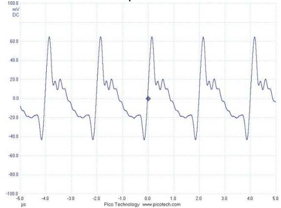
Figura 7 - Diagramma temporale del campo magnetico emesso da una saldatrice ad elettrodo in esercizio ad onda discontinua irregolare
