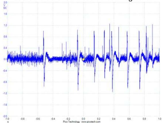
Figura 8 - Diagramma temporale del campo magnetico emesso da una saldatrice GMAW in esercizio ad onda continua irregolare
