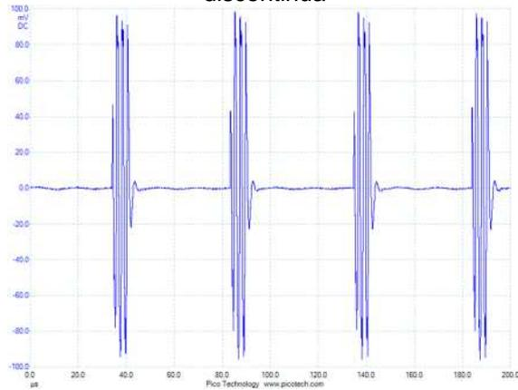
Figura 4 - Diagramma temporale del campo magnetico emesso da un radiobisturi in esercizio ad onda discontinua
